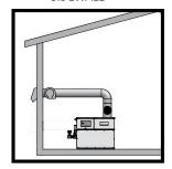
**POWERED SIDEWALL** W/DUCTED INTAKE
